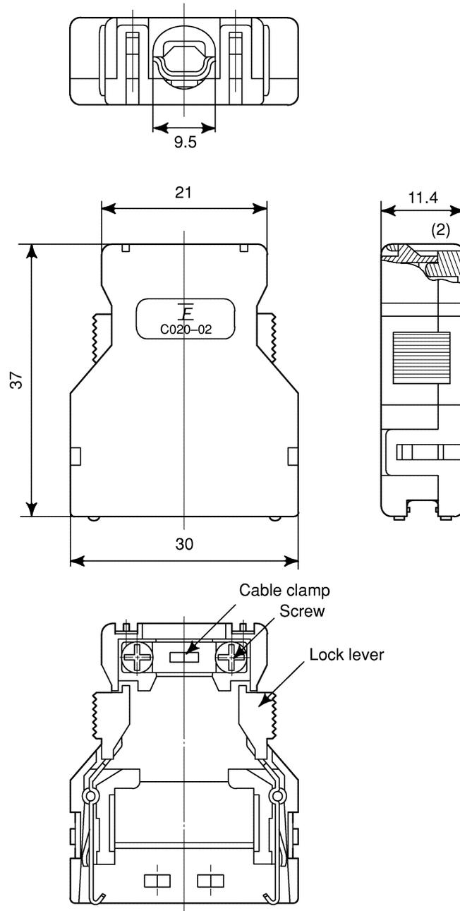
Fig. C2 (d) Connector case (PCR type (Hirose Electric))
