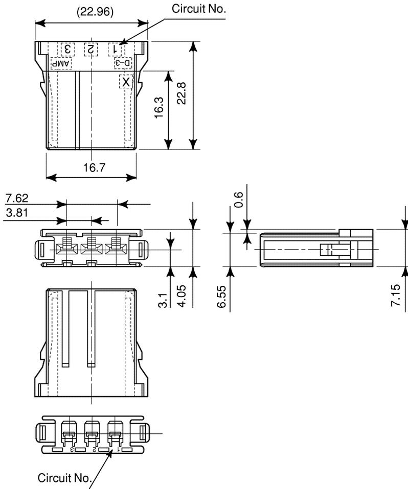
**Fig. C3 (d) AMP connector (4): For +24 V power supply**
