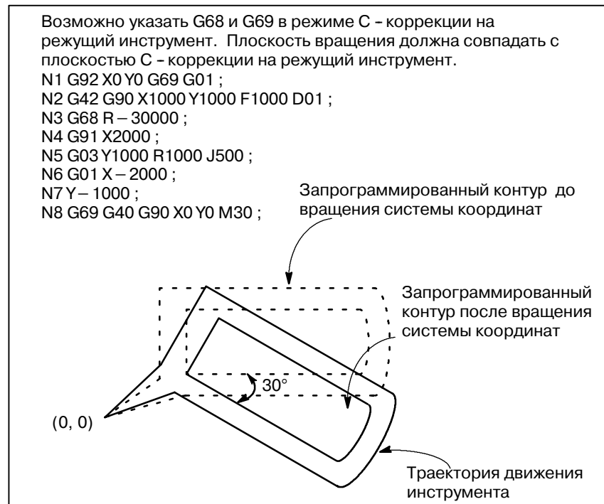
Рис. 14.8 (d) С - коррекция на режущий инструмент и вращение системы координат
