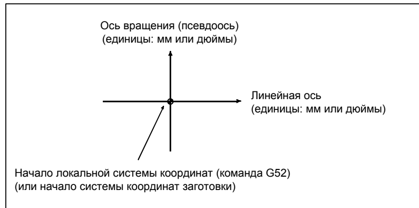
Рис. 3.1 (а) Плоскость интерполяции в полярных координатах.
