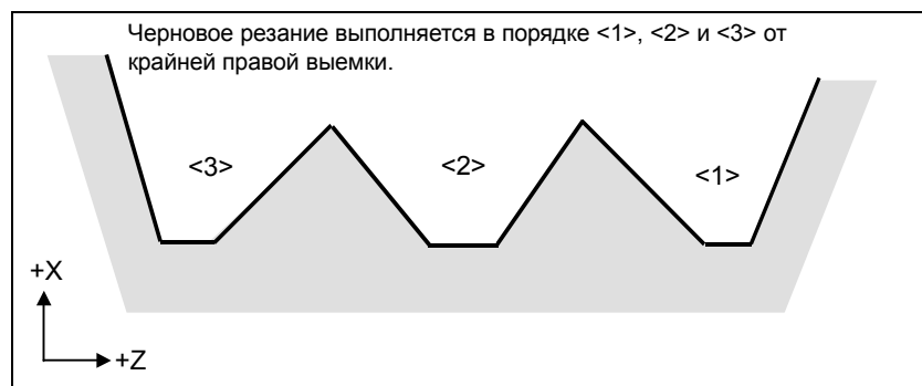
Рис. 4.2.1 (л) Порядок черного резания в случае монотонного убывания (тип II)
